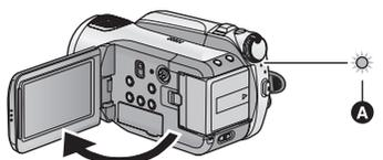
Индикатор статуса **A** горит красным светом и устройство переводится в режим паузы записи примерно через 0,6 секунды после включения.
