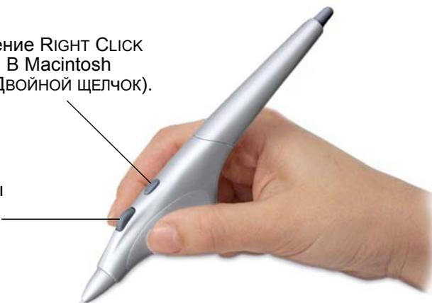
Дополнительный инструмент Intuos3, перо Art Pen (или оно же Art Marker) реагирует на давление, наклон и вращение пера.
