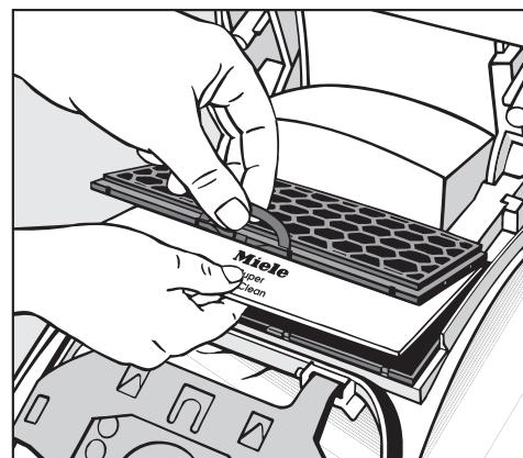
Встроенный в некоторые модели индикатор замены фильтра выходящего воздуха (клавиша сброса) настроен на цикл замены фильтров Active Air Clean и Active HEPA. Если Вы используете фильтр SUPER air clean, то загорание индикатора не имеет для Вас значения, так как этот фильтр Вы заменяете всегда, когда Вы открываете новую упаковку с пылесборниками Miele. Индикатор погаснет, как только Вы нажмете клавишу сброса.
