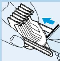
**2** Удерживая одной рукой кнопку фиксатора в нажатом положении, другой рукой снимите гребенчатую насадку с прибора.
