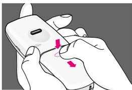
**1** Снять крышку с отделения батареек, нажав на стрелку.
