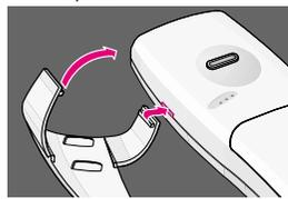
**1** Вставьте ленточную скобу в щель с одной стороны трубки.
