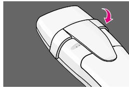
**2** Вставьте ленточную скобу в щель с другой стороны трубки до характерного щелчка.
