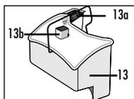
Резервуар для грязной воды (13), включая «мокрый» фильтр (13a) и поплавков (13b)\*\*
