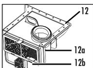
Комплект АКВА-фильтра (12) с губчатым фильтром (12a) и всасывающим фильтром (12b)\*\*
