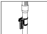
Изменяемая по высоте телескопическая всасывающая труба с фиксатором для стоячного положения
