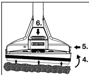
Снимите адаптер для твердых полов с распылительной насадки для чистки ковров потянув защелку вверх и нажав вовнутрь красный фиксатор на насадке. Вынуть адаптер для твердых полов из шарнира и снять его.
