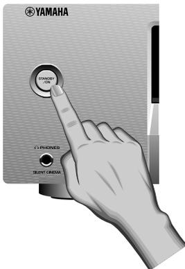
Данный аппарат устанавливается на режим ожидания. В режиме ожидания, данный аппарат потребляет малое количество электроэнергии для приема инфракрасных сигналов от пульта ДУ. Для включения данного аппарата от режима ожидания, нажмите **STANDBY/ON** (или **POWER**). Смотрите стр. 21 для более подробной информации.
