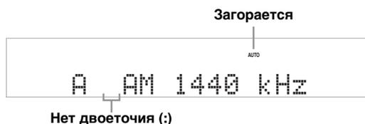
Автоматическая настройка невозможна при появлении двоеточия (:) на дисплее фронтальной панели. Нажав **② PRESET/TUNING**, отключите двоеточие (:).
