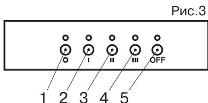
На лицевой панели вытяжки находится переключатель режимов работы мотора и ламп освещения (см. Рис.3):
