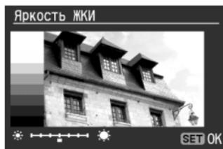
При проверке экспозиции изображения не допускайте, чтобы на изображение влияло внешнее освещение. Кроме того, рекомендуется устанавливать яркость ЖК-монитора в центре шкалы настройки.
