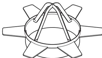
**1 штуцер воздуховода** позволяет изменить положение отверстия для воздуховода в потолке (не у приборов модельного ряда ...U).
