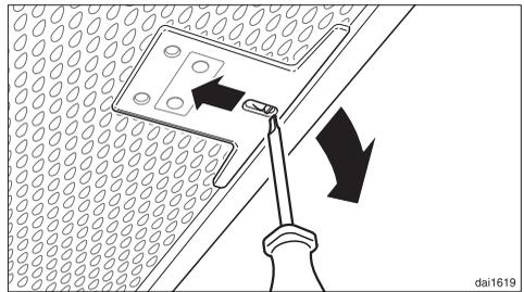
разблокируйте фильтры через выемки с помощью небольшой отвертки.
