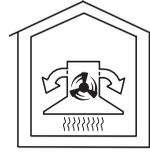
Всасываемый воздух очищается жирулавливающими фильтрами и дополнительно **угольным фильтром**. Через отверстия в телескопической трубе вытяжки воздух попадает обратно в кухню.
