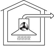
Всасываемый воздух очищается жирулавливающими фильтрами и выводится наружу.
