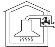
У кухонных вытяжек, для эксплуатации которых используется выносной вентилятор, всасывающий вентилятор устанавливается снаружи помещения в удобном для Вас месте.
