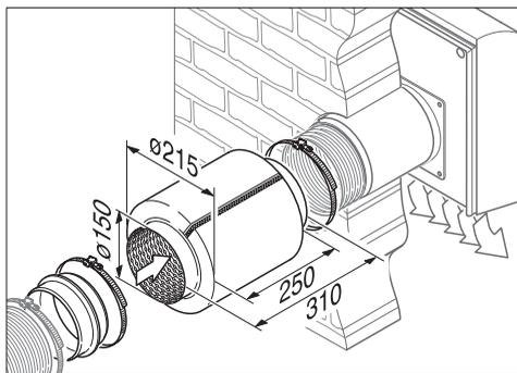
Для дополнительной звукоизоляции при эксплуатации вытяжки с выносным вентилятором рекомендуется установка шумоподавителя.
