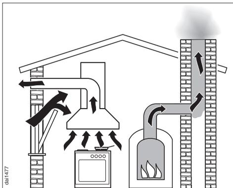
Этого можно добиться, если с помощью постоянно имеющихся отверстий, например, незакрывающихся форточек в дверях и окнах, обеспечить дополнительное поступление воздуха, необходимого для горения. При этом нужно проследить, чтобы сечение такого отверстия было достаточного размера.
