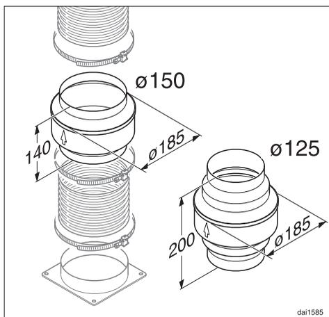
Кроме оснащения воздуховода соответствующей изоляцией, рекомендуется также монтаж данной заслонки, которая улавливает и испаряет образующийся конденсат. Соответствующую заслонку можно приобрести для воздуховода  $\varnothing 125$  или  $\varnothing 150$  мм.
