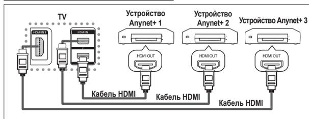
С помощью кабеля HDMI соедините гнездо [HDMI 1], [HDMI 2] или [HDMI 3] на телевизоре с гнездом HDMI OUT соответствующего устройства Anynet+.
