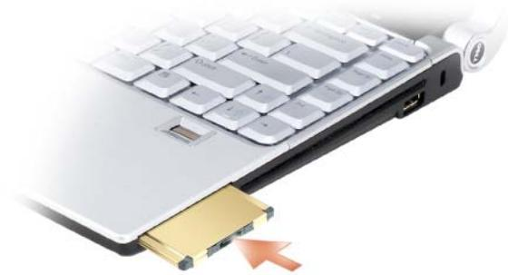
Операционная система компьютера распознает плату ExpressCard и автоматически загружает соответствующий драйвер устройства. Если программа конфигурирования выдаст запрос на загрузку драйверов производителя, используйте диск, который прилагается к плате ExpressCard.
