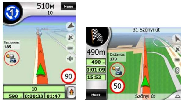
При приближении к первой из камер контроля участка отображаются те же данных, что и на фиксированной камере (предел скорости и расстояния). Находясь между двумя камерами над значком предела скорости отображается постоянно обновляемая средняя скорость.
