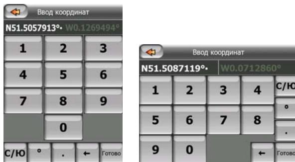
При переходе к данном окну координаты текущего GPS-положения (или выбранного пункта карты; элемент Курсор, если функция Автоследование отключена) отображаются в верхней части дисплея.
