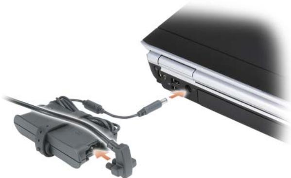
**⚠ ПРЕДУПРЕЖДЕНИЕ.** Адаптер переменного тока работает с электрическими розетками, используемыми во всем мире. Тем не менее, в разных странах используются разные разъемы электропитания и сетевые фильтры. Использование несовместимого кабеля, а также неправильное подключение кабеля к удлинителю или электросети может привести к повреждению оборудования или пожару.
