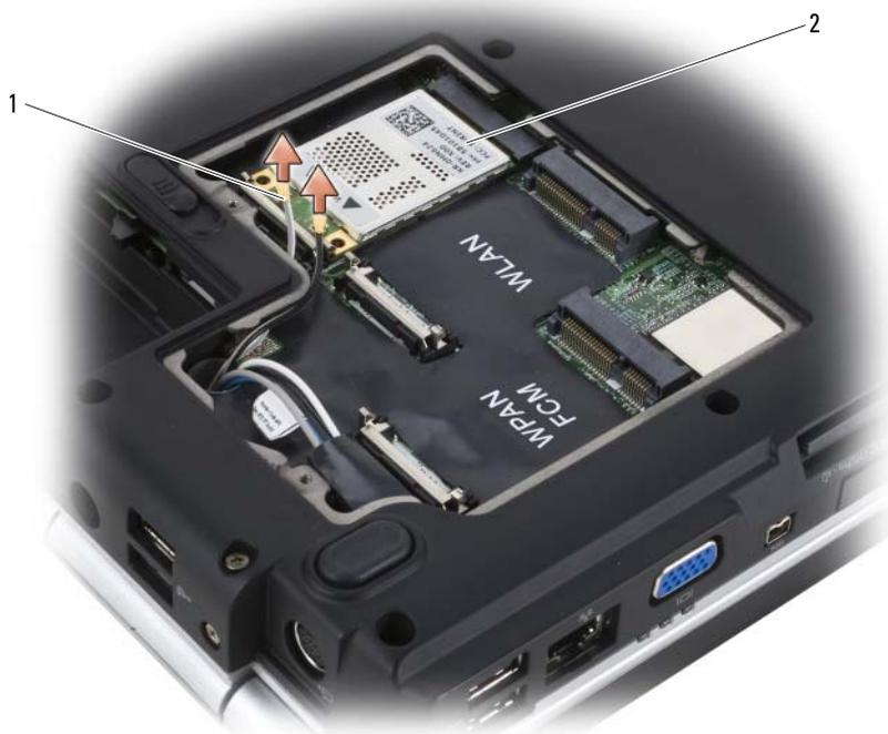
1 разъемы кабеля антенны (2)      2 плата WWAN
