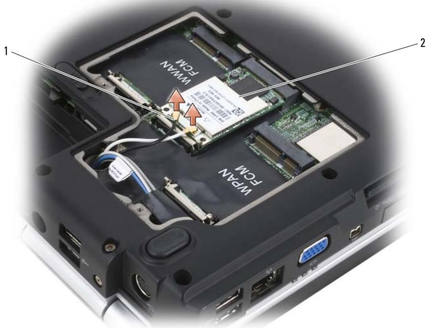
1 разъемы кабеля антенны (2)      2 плата WLAN
