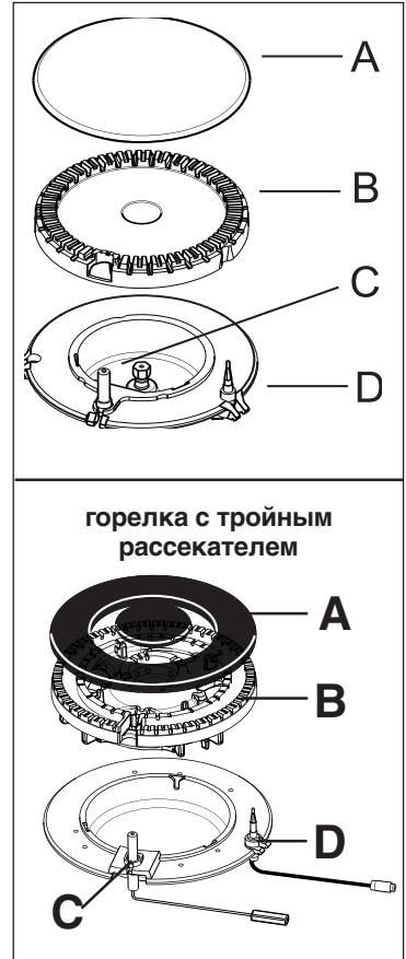
Рис. 1 A - Крышка B - Рассекатель горелки C - Свеча зажигания D - Термопара
