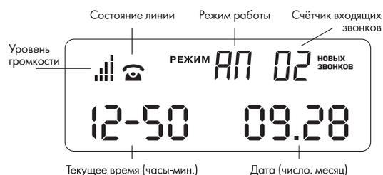
Рис. 1. Индикация на дисплее в основном состоянии
