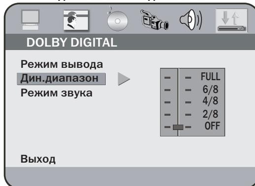
Данная настройка (иногда также называемая системой выделения речи) служит для сжатия динамического диапазона (т. е. измеряемой в децибелах разницы между самыми тихими и громкими звуками на звуковой дорожке). Регулировка настройки **ДИН. ДИАПАЗОН** позволяет снизить неприятные эффекты от, например, чересчур громких батальных сцен и улучшить восприятие диалогов.
