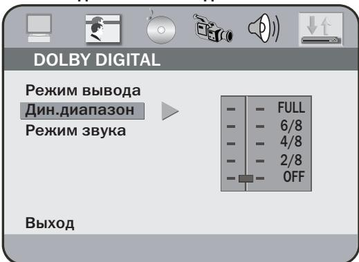
Данная настройка (иногда также называемая системой выделения речи) служит для сжатия динамического диапазона (т. е. измеряемой в децибелах разницы между самыми тихими и громкими звуками на звуковой дорожке). Регулировка настройки **ДИН. ДИАПАЗОН** позволяет снизить неприятные эффекты от, например, пересчур громких батальных сцен и улучшить восприятие диалогов.
