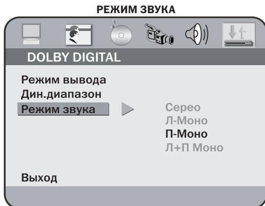
Выбор сигнала для усилителя/декодера с выходом Dolby Digital: **Стерео**, **Л-моно** (на аудиовыходы фронтальных АС подается сигнал только левого канала), **П-моно** (сигнал только правого канала) или **Л+П моно** (смешанный сигнал левого и правого каналов).
