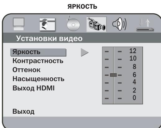
Регулировка яркости изображения. Нажмите кнопку **ENTER** на ПДУ, на экране появится шкала настройки. С помощью кнопок **▼▲** установите желаемый уровень яркости изображения. Для подтверждения своего выбора и возврата в меню настройки цвета нажмите кнопку **ENTER**.
