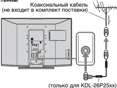
Подключение антенны и видеомагнитофона
