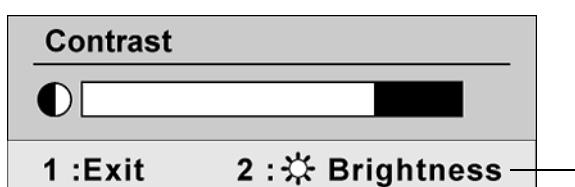
Строка в нижней части экрана предлагает дальнейшие действия: выход из меню или выбор регулировки яркости.
