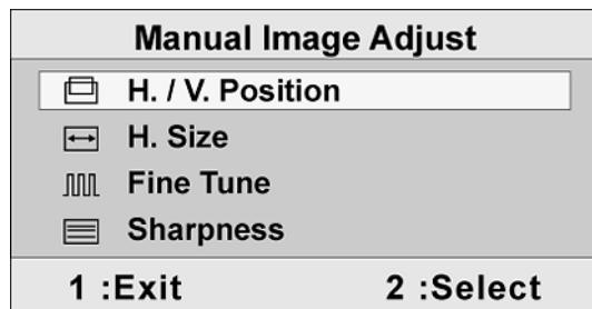
**H. Size (Размер по горизонтали)** регулирует ширину изображения на экране.
