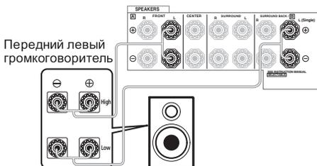
Поскольку на разъемы переднего и заднего громкоговорителей объемного звучания выводится один и тот же аудиосигнал, не важно какой из наборов (передние или задние объемного звучания) подключен к каким разъемам (**High** или **Low**) громкоговорителя.
