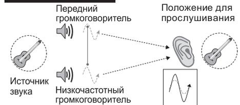
Технология корректировки фазы обеспечивает когерентность воспроизведения звука, благодаря согласованию фазы<sup>4</sup> для обеспечения оптимального звукового поля в точке прослушивания. По умолчанию функция включена, и при выходе из меню Phase Control (Управление фазой) рекомендуется оставлять ее включенной для всех источников звука.
