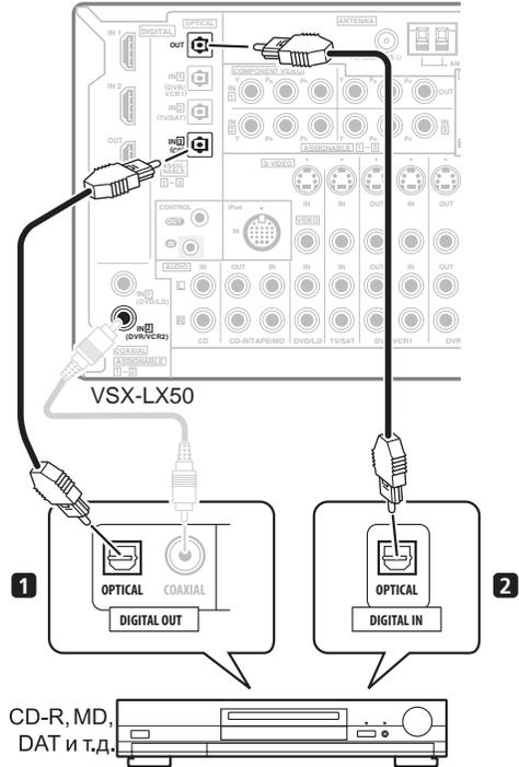
**1 Соедините цифровой аудиовыход оптического типа<sup>1</sup> используемого цифрового компонента со входом DIGITAL 3 (CD).**
