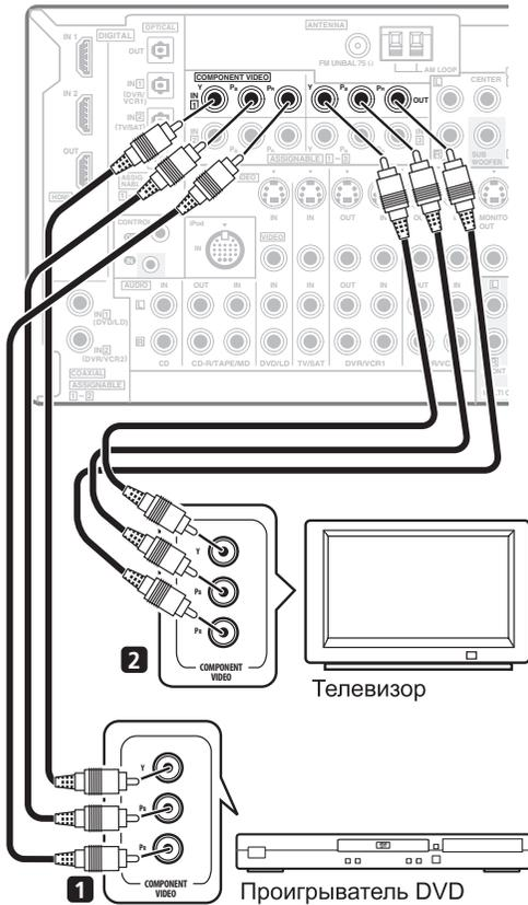
**1 Соедините выходы компонентного видео источника с набором входов ASSIGNABLE COMPONENT VIDEO.**
