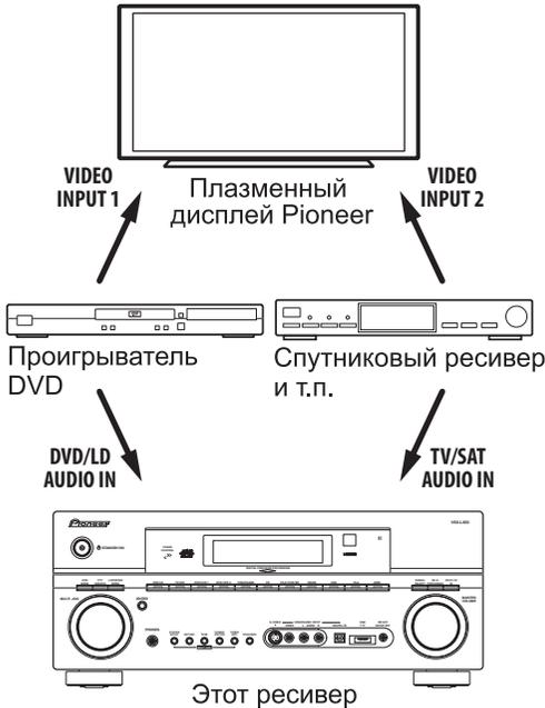
Для оптимального использования функций SR+ следует подключить компоненты-источники сигнала (проигрыватель DVD и т.д.) немного иначе по сравнению с тем, как описано в данном разделе. Подключите видеовыходы каждого компонента непосредственно к плазменному дисплею, а аудиовыходы (аналоговые и/или цифровые) – к ресиверу.
