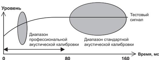
Звук, исходящий из акустической системы, испытывает влияние помещения – его стен, мебели и размеров. Чем меньше время отклика, при котором проводится частотный анализ, тем меньше на него влияет помещение. Рекомендуется установить время отклика 20 мс до 40 мс для компенсации двух основных факторов, влияющих на звучание в большинстве помещений:
