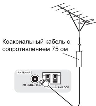
Для улучшения приема в диапазоне AM подключите к разъемам **AM LOOP** провод длиной 5 м до 6 м с виниловой изоляцией, не отсоединяя прилагаемую рамочную антенну AM.
