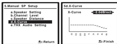
**2 Выберите нужную настройку X-Curve (Кривая X).** Используйте кнопки **←/→** для регулировки настройки. X-Curve выражается в убывании наклона децибел на октаву, начиная с 2 кГц. Звук становится менее резким по мере увеличения наклона (до максимум **-3.0dB/oct**). Для настройки функции X-Curve в соответствии с размерами помещения используйте следующие указания:
