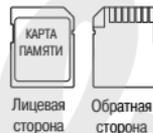
Расположив карту памяти обратной стороной вверх (в направлении той стороны камеры, где находится экран монитора), вставьте карту до упора в карточный слот и нажимайте на нее до тех пор, пока карта с отчетливым щелчком не зафиксируется надежно на месте.
