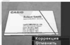
На дисплей будет выведен экран, который показывает все прямоугольные контуры на изображении, которые определены программой в качестве вариантов коррекции трапецеидальных искажений.
