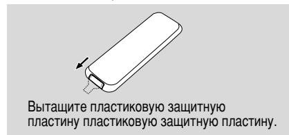
Вытащите пластиковую защитную пластину пластиковую защитную пластину.
