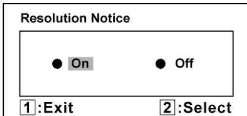
Если Resolution Notice (Информация о разрешении) включена и разрешение, установленное в компьютер, отличается от 1680 x 1050, появляется следующий экран.
