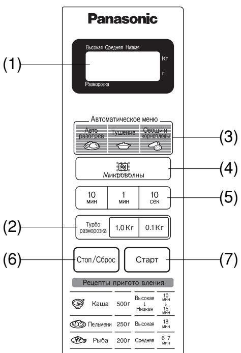
**(1) Окошко дисплея****(2) Клавиша турборазморозки Turbo Defrost****(3) Сенсорные кнопки Автоматического меню****(4) Кнопка установки мощности микроволнового режима****(5) Кнопка установки времени****(6) Кнопка остановки/сброса программы Стоп/Сброс****Перед приготовлением:**
