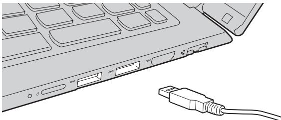
При первом подключении устройства USB к одному из USB-портов компьютера ОС Windows автоматически устанавливает драйвер для данного устройства. После установки драйверов устройство можно подключать и отключать без каких-либо дополнительных действий.
