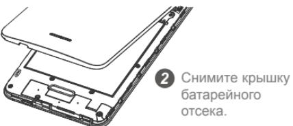
2 Снимите крышку батарейного отсека.
