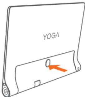
**Шаг 1.** Нажмите кнопку отсоединения опоры, чтобы отсоединить последнюю.
