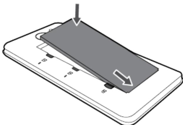
4 Закройте крышку батарейного отсека.
