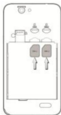
Micro-SIM – это уменьшенная SIM-карта(размерами 12мм x15мм). Она функционирует так же, как обычные SIM-карты. Слово «Micro-SIM» на телефоне используется только для определения функций мобильного телефона и информирования потребителей.
