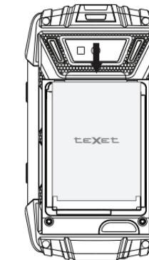
**ВНИМАНИЕ!** Не прикладывайте слишком большое усилие при закручивании крепежных винтов, так как этим Вы можете повредить крепления крышки АКБ. Повреждения такого рода ведут к нарушению герметизации устройства, что может послужить причиной проникновения жидкостей внутрь устройства и, как следствие, снятию устройства с гарантии.
