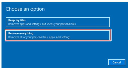
2. Если в компьютере имеется несколько жестких дисков, на экран выводится окно для выбора [Only the drive where Windows is installed] (Только тот диск, на котором установлена ОС Windows) или [All drives] (Все диски).
