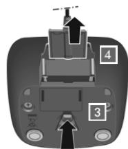
Чтобы отсоединить штекер от зарядного устройства, нажмите кнопку фиксатора **3** и отсоедините штекер **4**.
