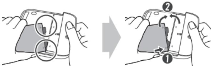
2 Совместите аккумулятор с нижней кромкой и осторожно вставьте модуль плавным движением обратно в устройство.
