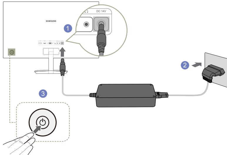
1 Подключите кабель питания к адаптеру питания постоянного тока. Затем подключите адаптер питания постоянного тока к порту **DC 14V** на задней панели устройства.
