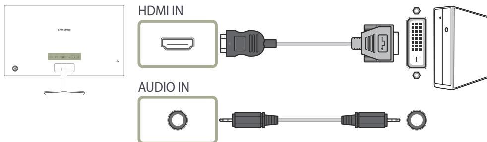
— Функция воспроизведения звука не поддерживается, если устройство подключается с помощью кабеля HDMI-DVI.
