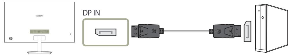
— Рекомендуется использовать кабель DP длиной до 1,5 м. Использование более длинного кабеля может повлиять на качество изображения.
