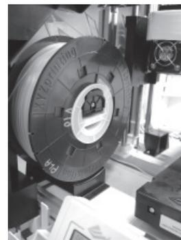
Сначала отведите рычаг фиксатора, затем вытяните нить, вращая втулку катушки. Смотайте нить на катушку для дальнейшего использования.
