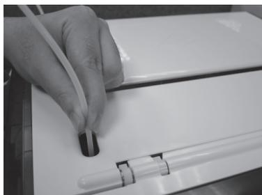
**3** Выведите направляющую трубку через зону перемещения трубки наружу из принтера, а затем вставьте другой конец направляющей нити в отверстие для трубки на подающем модуле.
