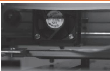
1. Рекомендуемое расстояние между соплом и платформой (с плотно наклеенной прокладкой) должно быть таким, чтобы через зазор беспрепятственно проходили два листа бумаги формата A4.
