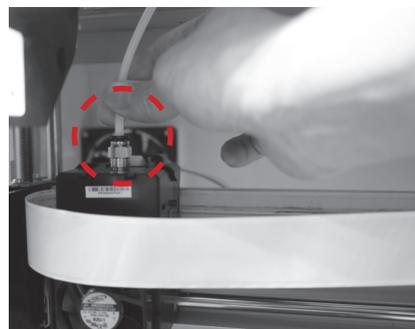
**1** Перед установкой направляющей трубки выключите принтер и переместите экструдер в крайний левый конец оси X. В противном случае качество печати может снизиться.
