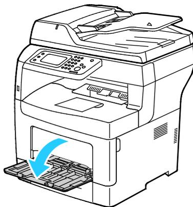
2. Чтобы снять обходной лоток с принтера, вытяните его.
