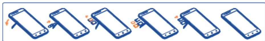
Для установки или извлечения SIM-карты или microSD-карты воспользуйтесь входящим в комплект инструментом для извлечения SIM-карты/microSD-карты: вставьте его в небольшое отверстие на крышке слота SIM-карты/microSD-карты и слегка надавите на него до щелчка.
