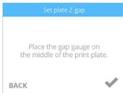
3. Аккуратно проведите измерительный щуп между печатной площадкой и левым печатным соплом. С помощью кнопок-стрелок поднимайте или опускайте печатную площадку до тех пор, пока не почувствуете легкое сопротивление щупа. Установите **флажок**, когда почувствуете подходящий уровень сопротивления.
