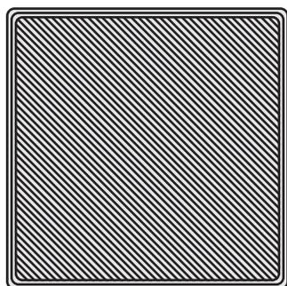
Если зазор слишком большой, первый слой может стать шершавым при снятии модели с печатной площадки.
