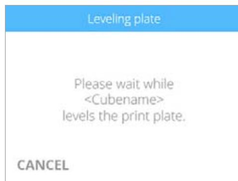
3. После завершения выполнения автоматического определения уровня установите **флажок**, чтобы проверить промежуток по оси Z (шаг 8). Если параметры печатной площадки не совпадают со значениями спецификации, продолжите процедуру.
