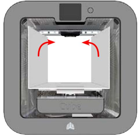
7. Вручную поднимите печатную платформу (A) и извлеките разделитель (B) из принтера.
