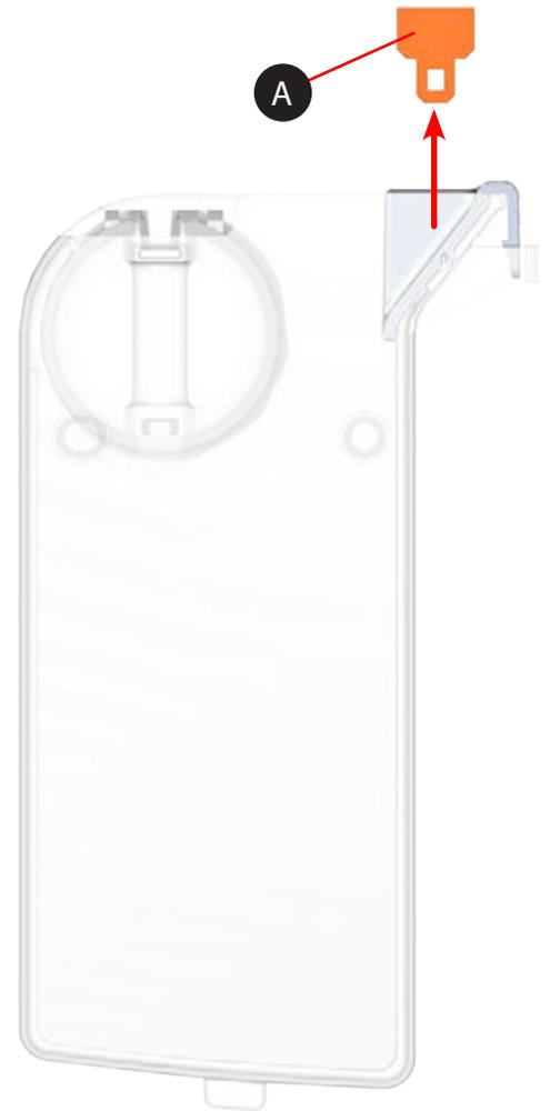
3. Установите новый очиститель сопел в очистной резервуар и установите резервуар обратно в принтер.
