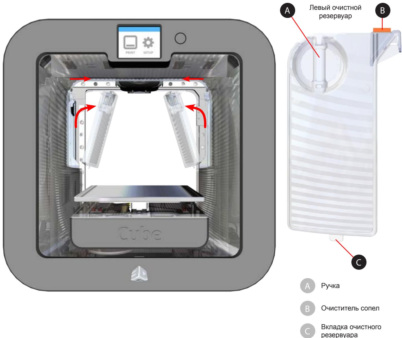
С помощью рукоятки потяните верхнюю часть очистных резервуаров внутрь, а затем вверх, чтобы извлечь нижнюю вкладку из щели.
