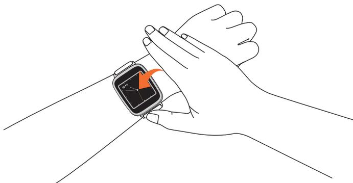
Для затемнения сенсорного экрана ASUS ZenWatch закройте циферблат ладонью.
