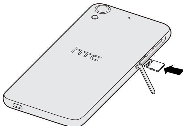
3. Чтобы закрыть крышку слотов, задвиньте пластиковый шарнир внутрь боковой стороны корпуса и прижмите крышку до фиксации со щелчком.
