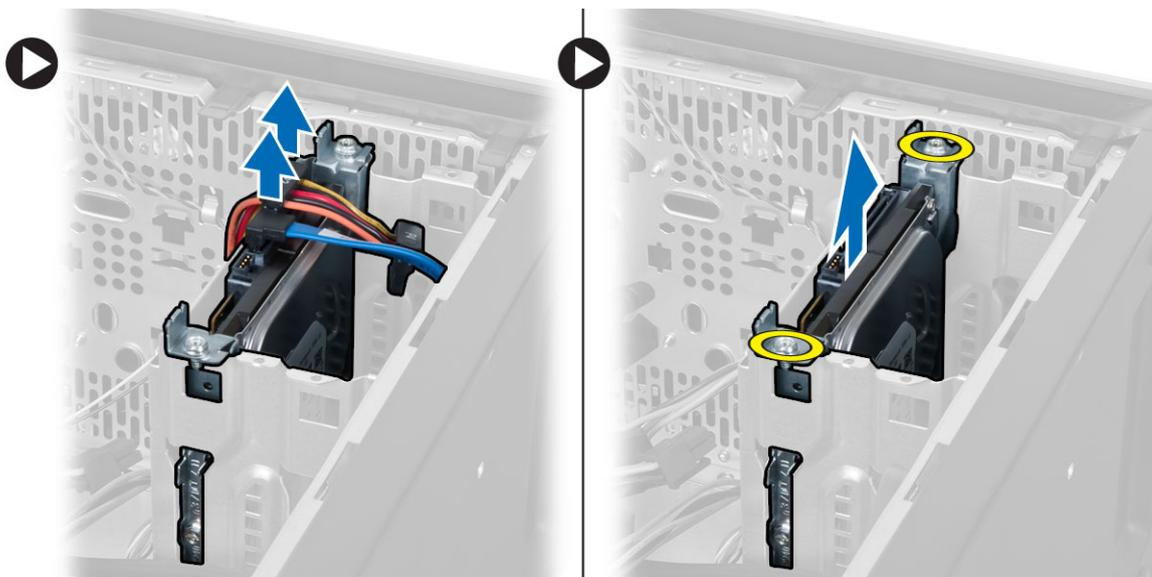
4. Чтобы извлечь отсек жесткого диска, необходимо выполнить следующие действия:
