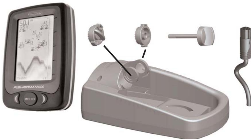
Для монтажа головного устройства Вам понадобятся левая и правая зубчатые шпонки и стопорный болт.
