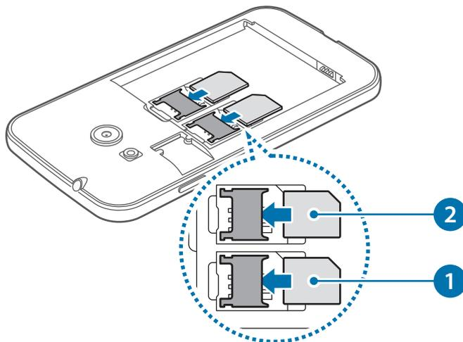
► **Модели с одной SIM-картой:** вставьте SIM- или USIM-карту в устройство золотистыми контактами вниз.
