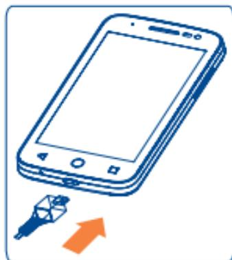
Подключите зарядное устройство к телефону и стандартной бытовой розетке переменного тока (220 В, 50 Гц), как показано на рисунке, загорится светодиодный индикатор.
