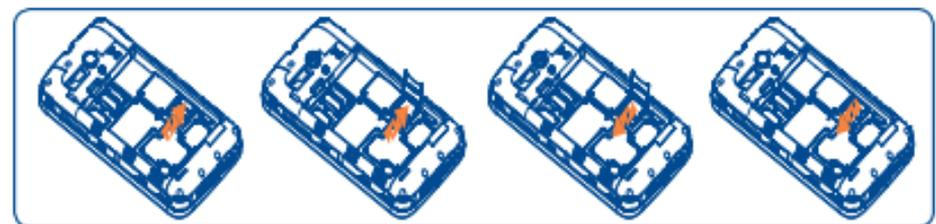
Для установки microSD-карты, сдвиньте металлический держатель вправо в положение ОТКРЫТЬ, нажмите и отпустите, чтобы разблокировать его. Вставьте microSD-карту в слот контактами вниз. После этого, закройте лоток и сдвиньте влево, чтобы заблокировать его. Для извлечения microSD-карты, сдвиньте и разблокируйте лоток, затем аккуратно выдвиньте microSD-карту из слота.
