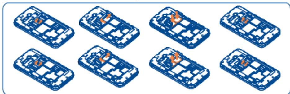
Для установки SIM-карты, сдвиньте металлический держатель в положение ОТКРЫТЬ, нажмите и отпустите, чтобы разблокировать его. Вставьте SIM-карту в слот контактами вниз. После этого, сдвиньте лоток в положение ЗАКРЫТЬ, нажмите и заблокируйте его. Для извлечения SIM-карты, сдвиньте и разблокируйте лоток, затем аккуратно выдвиньте SIM-карту из слота.
