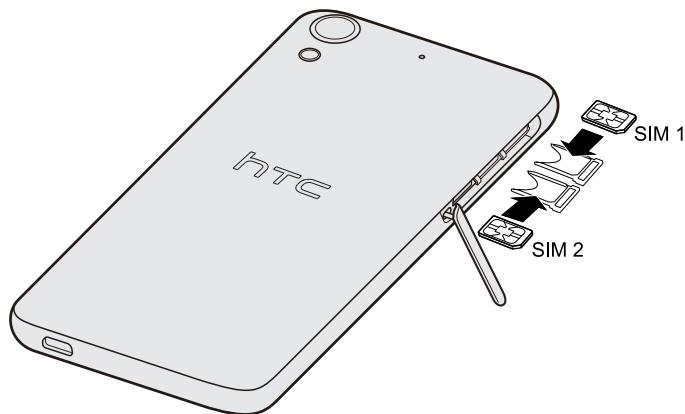
5. При установке лотков на место убедитесь, что они направлены вверх, чтобы предотвратить выпадение из них nano-SIM-карт. Задвиньте лотки в слоты до упора.
