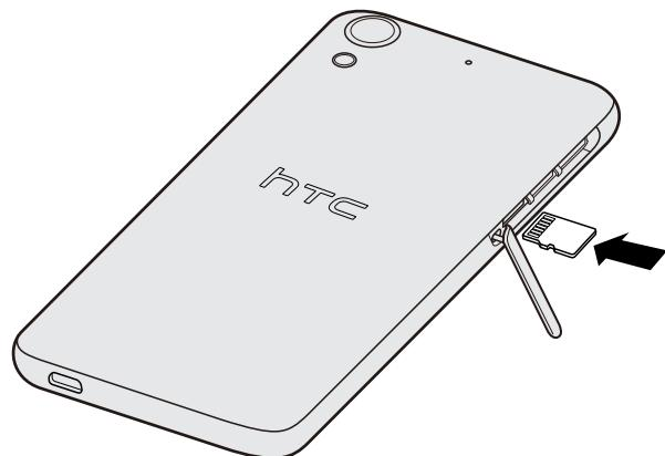
3. Чтобы закрыть крышку слотов, задвиньте пластиковый шарнир внутрь боковой стороны корпуса и прижмите крышку до фиксации со щелчком.
