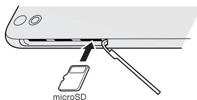
3. Чтобы закрыть крышку слотов, задвиньте пластиковый шарнир внутрь боковой стороны корпуса и прижмите крышку до фиксации со щелчком.
