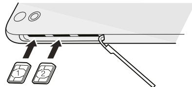
4. Чтобы закрыть крышку слотов, задвиньте пластиковый шарнир внутрь боковой стороны корпуса и прижмите крышку до фиксации со щелчком.
