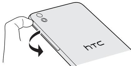
3. В верхний слот вставьте nano-SIM-карту (позолоченными контактами вверх, скошенным угломком внутрь) и нажмите на нее до фиксации со щелчком.
