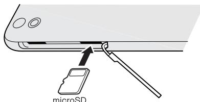
3. Чтобы закрыть крышку слота, слегка поддвигайте ее из стороны в сторону, чтобы резиновый шарнир самостоятельно встал на место. Затем аккуратно прижмите крышку к корпусу.
