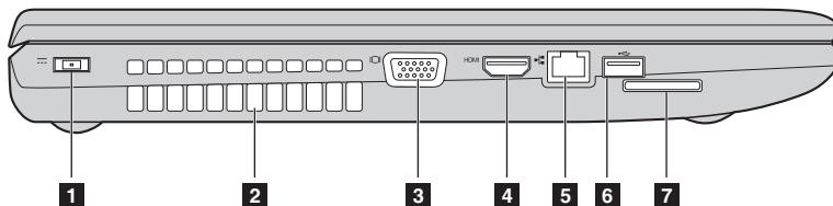
**1 Гнездо адаптера питания** Предназначено для подключения адаптера питания.
