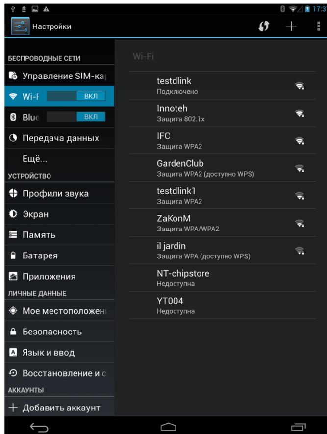
2. Справа будет отображен список доступных сетей Wi-Fi. Чтобы подключиться к одной из открытых или защищенных паролем сетей Wi-Fi, следует коснуться названия сети, при необходимости ввести пароль.
