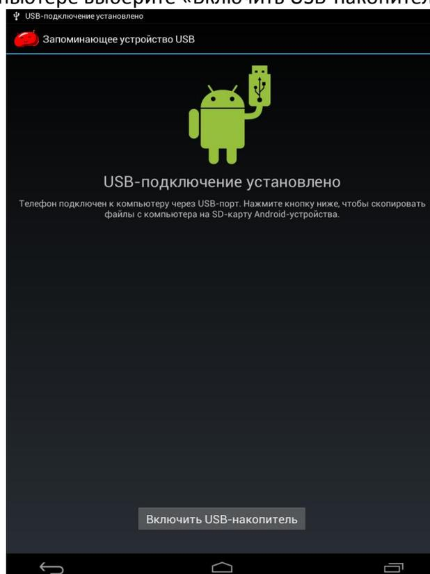
3. На персональном компьютере планшет определится как съемный диск или как два съемных диска, если в планшетный компьютер установлена карта памяти microSD.
