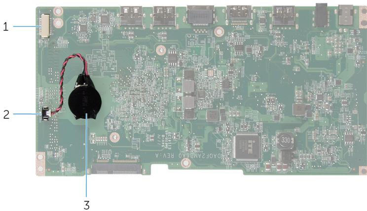
1 разъем кабеля платы камеры и кнопок управления
